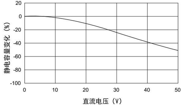
2. 高介电常数型电容器的静电容量会随施加的交流电压而变化。
