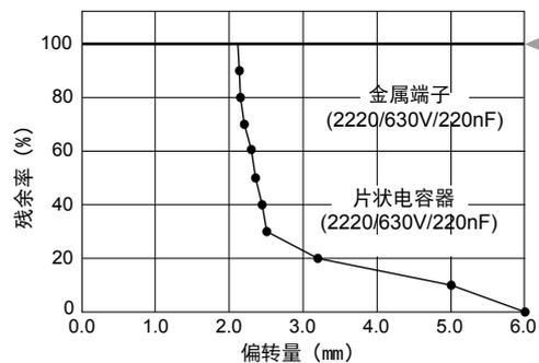
● 减少了因热应力造成的焊接裂纹。
