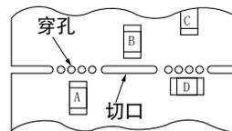
\*1 在手动分离条件下对穿孔施加垂向应力时， $A > D$ 有效。使用切削盘时，应力与PCB呈对角，此时 $A > D$ 无效。
